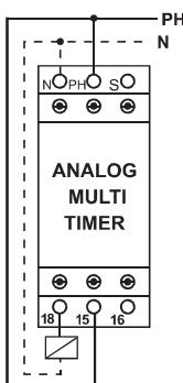
در صورتی که ترمیتال SELECT به فاز و مول گردد ، دستگاه به صورت تایمر دقیقه و چنانچه ترمیتال آزاد باشد دستگاه به صورت تایmer ثانیه عمل می کند.
